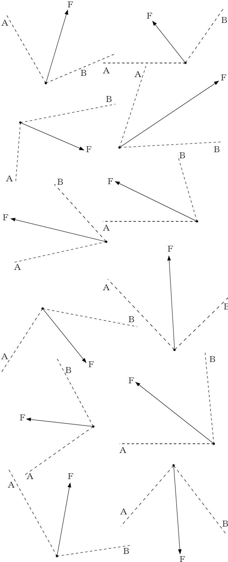
問題2 重力Wの物体をA方向とB方向で支えるときの力Aと力Bを作図せよ。
