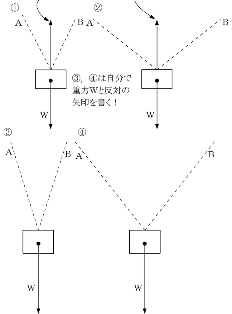
問題3 斜面上に置いた物体の重力Wを, 斜面にその方向Aと斜面に垂直な方向Bに分解し, その分力A, 分力Bを作図せよ。
