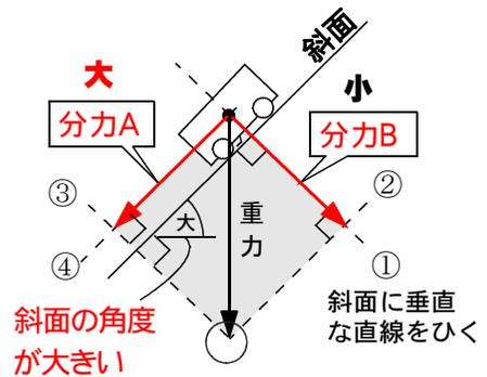
斜面の傾きが**大きくなる**と、物体にはたらく重力の斜面にそつ分力Aは **大きくなり**、斜面に垂直な分力Bは **小さくなる**。
