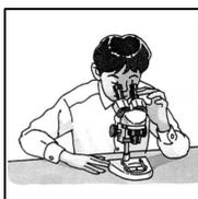
ケ ③ **右目** コ の視力に合わせるため、**右目だけ** サ でのぞきながら、**調節ねじ** シ を回して観察する部分がはっきり見える位置にあわせる。
