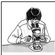
カ ② **粗動ねじをゆるめ** キ て **鏡筒** きやうとう を上下させ、およそのピントを合わせて **鏡筒** ク を固定する。
