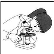
④ プレパラートをステージの上ののせ、真横から見ながら **調節ねじ** を回しながらプレパラートと対物レンズをできるだけ **近づける**。
